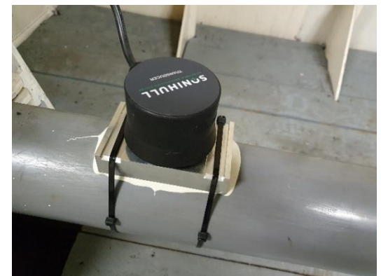
Transducer op een leiding m.b.v. een pipe adaptor
